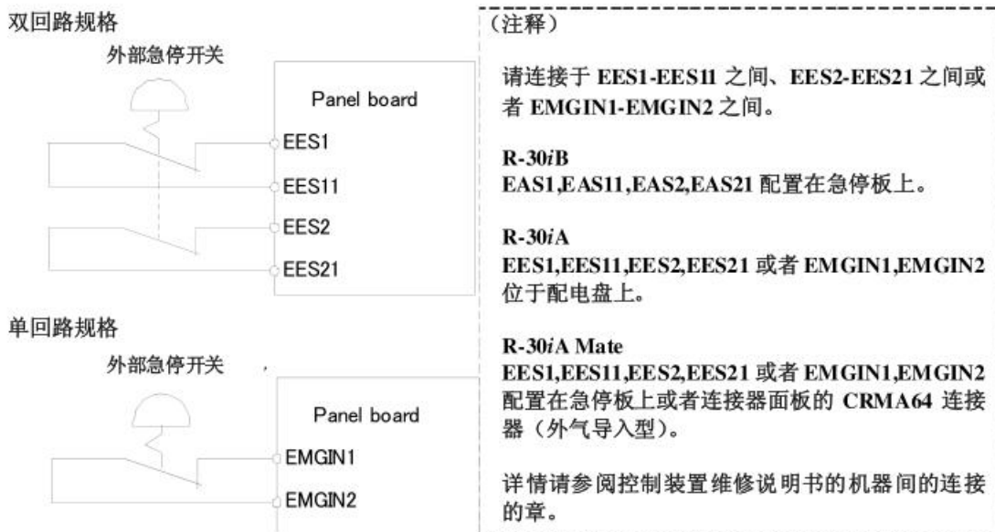
图 3.1 外部急停按钮的连接图
